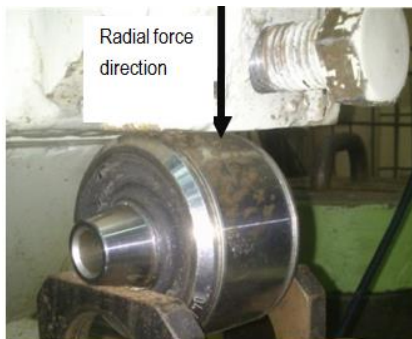
Fig. 3b. Actual bushing installed in test rig
